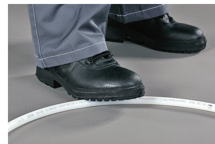
Надломил трубу из сшитого полиэтилена.
