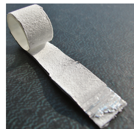
Пример качественно проклеенной трубы после расслоения. Адгезив нанесён равномерно, полосы не проклея отсутствуют.
