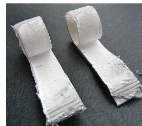
Примеры некачественно проклеенных труб. Адгезив нанесён неравномерно, имеются полосы без клея.
