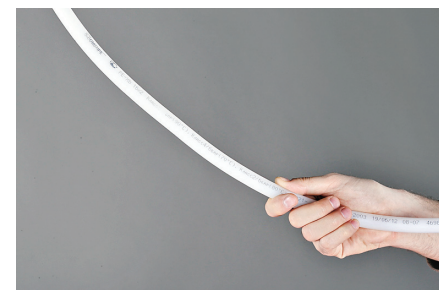
После остывания труба принимает первоначальный вид.
