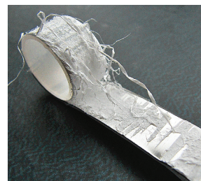
Примеры некачественно проклеенных труб. Адгезив нанесён неравномерно, имеются полосы без клея.
